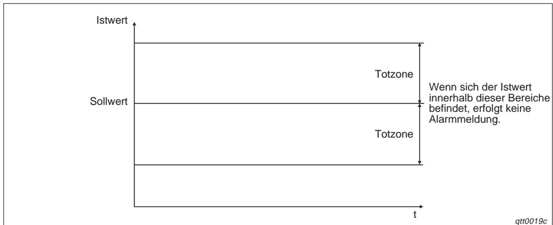
**Abb. 4-13:** Bereiche, in denen die Überwachung des Regelkreises deaktiviert ist
